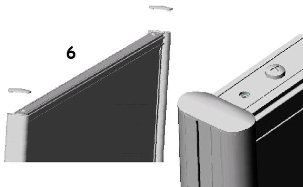
\* A l'aide d'une visseuse électrique, fixer le 1<sup>er</sup> auget sur le profil bas du panneau en plaquant une Extrémité sur le pied
